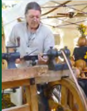
ANDREAS ZIMMERMANN führt das Drechseln an einer 160 Jahre alten Tretmaschine vor.
